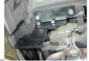
**ШАГ 3.** Установите кронштейн левый, совместив отверстия кронштейна с отверстиями в лонжероне автомобиля и соедините их с закладными пластинами с помощью болтов М10х40 через шайбы 10 и шайбы 10 гроверные.
