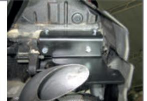
**ШАГ 4.** Установите балку ТСУ, совместив отверстия с отверстиями в боковых кронштейнах и соедините их с помощью болтов М10х40 через шайбы и шайбы 10 гроверные.
