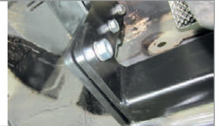
**ШАГ 5.** Установите кронштейн розетки и закрепите его с помощью болта М10, шайбы 10 гроверной и шайбы 10. Затяните все соединения, отрегулировав положение ТСУ. Установите съёмный шар в сборе и закрепите его пальцем гнутым гальванизированным со шплинтом пружинным игольчатым. Затяните шар ключом на 38 мм. Установите задний бампер, согласно руководства по ремонту автомобиля.
