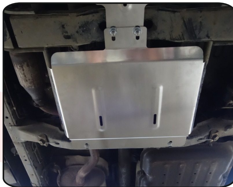
Защита раздаточной коробки (алюминий) 4мм арт.ZKTCC00123
