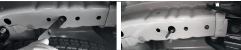
**ШАГ 2(2)** Установите кронштейн боковой с внутренней стороны лонжерона, гибом к центру авто и прикрутите его с помощью болтов M12x1,25x110, продетых сквозь лонжерон, гайками M12x1,25, через шайбы 12 и шайбы 12 гроверные.
