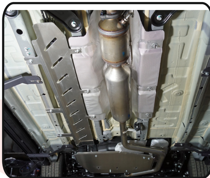
Защита топливopовода (алюминий) 4 мм арт. ZKTCC00611.
