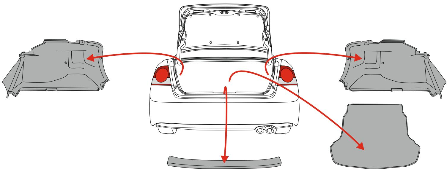
Элементы обшивки, которые рекомендуем демонтировать перед установкой комплекта проводки.
