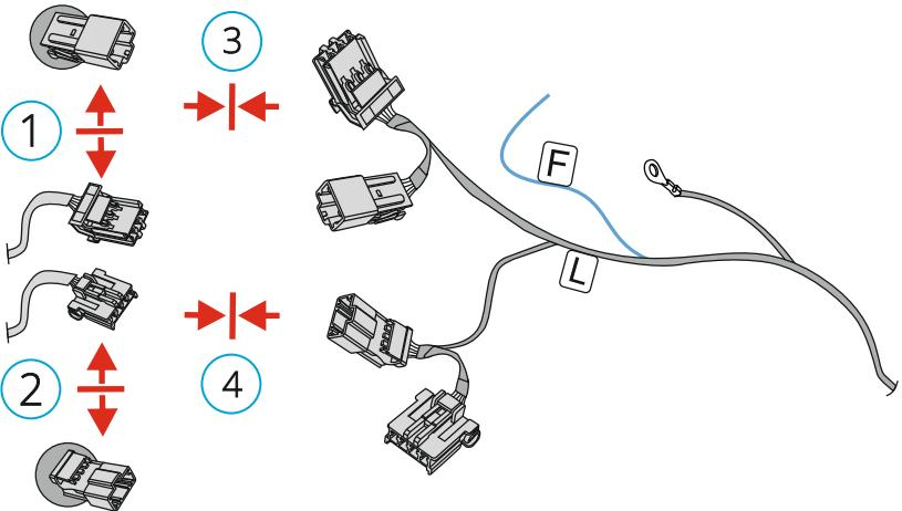
Соедините колодки до щелчка, в порядке, указанном на рисунке, надежно закрепите.
