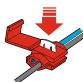
4. Задавите металлическую часть «зажим» в тело провода, не повредив медную жилу кабеля.
