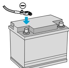
После всех проведенных работ подключите минусовую клемму аккумулятора, преимущественно руководствуйтесь рекомендациями производителя автомобиля.
