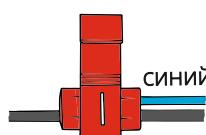
3. Установите в ответвитель синий провод «F» из комплекта и провод автомобиля, определенный в п. 1 данного раздела.
