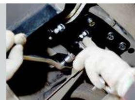
**ШАГ 5.** Закрепите кронштейн крепления электрической розетки гайкой М10 с шайбой. Установите съемный шар в сборе и закрепите его пальцем гнутым со шплинтом. Зафиксируйте съемный шар болтом М10х20. Установка завершена.
