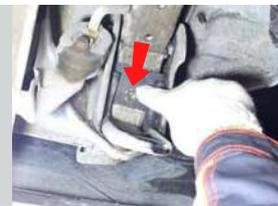
**ШАГ 2.** Установите кронштейн (поз. Q) и прикрутите его с помощью болтов М12х110х1,25 продетых сквозь лонжерон, гайками М12х1,25 через шайбы на 12 и шайбы пружинные на 12. Кронштейн устанавливается с внутренней стороны лонжерона гибом в центр автомобиля.
