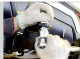
Тип соединения: шаровый; Диаметр сцепного шара: 50 мм.; Масса комплекта ТСУ MAS991101 : 16,8 кг.
