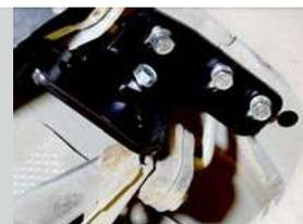
**ШАГ 4.** Для установки кронштейна сварного совместите отверстия в кронштейне с резьбовыми отверстиями боковых кронштейнов и соедините помощью болтов М10х30х1,25, через шайбы на 10. Затяните все резьбовые соединения.
