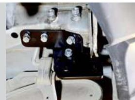
**ШАГ 3.** Установите пластию гнутую (поз. Р) и прикрутите её к лонжерону с помощью болтов М10х40х1,25 через шайбы на 10 и к кронштейну с помощью болта М10х30х1,25 через шайбы на 10 с двух сторон, шайбы пруж. на 10 и гайки М10х1,25. Повторите шаги 2-3 для другой стороны.
