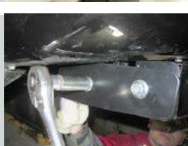
**ШАГ 6.** Установите съемный шар в сборе и закрепите его пальцем гнутым со шплинтом. Зафиксируйте съемный шар болтом M10x20 снизу. Затяните съемный шар с помощью ключа на 38 мм. Установка завершена.
