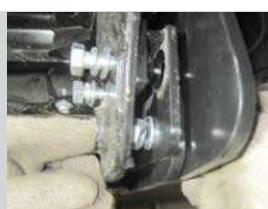
**ШАГ 5.** Отрегулируйте положение фаркопа и затяните все резьбовые соединения.
