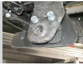
**ШАГ 4.** Установите кронштейн центральный совместив отверстия в центрального кронштейна с отверстиями боковых кронштейнов и соедините их с помощью болтов M12x45x1,25 через шайбы на 12 и гроверы на 12, гайками M12x1,25. Соединения не затягивать.
