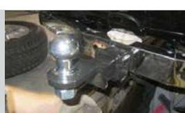
Тип соединения: шаровый; Диаметр сцепного шара: 50 мм.; Масса комплекта ТСУ HVH991101: 24,0 кг.
