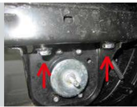
**ШАГ 2.** Установите кронштейн правый и закрепите его двумя болтами M12x45x1,25 с юбкой к штатным закладным гайкам. Кронштейн с левой стороны устанавливается аналогично. Соединения не затягивать.
