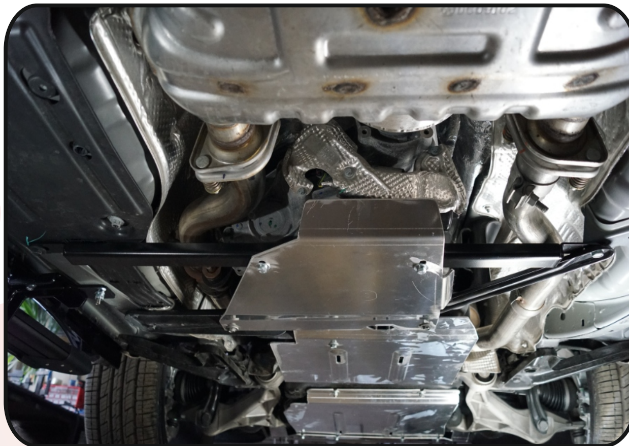
Защита раздаточной коробки (алюминий) 4 мм арт. ZKTCC00354.
