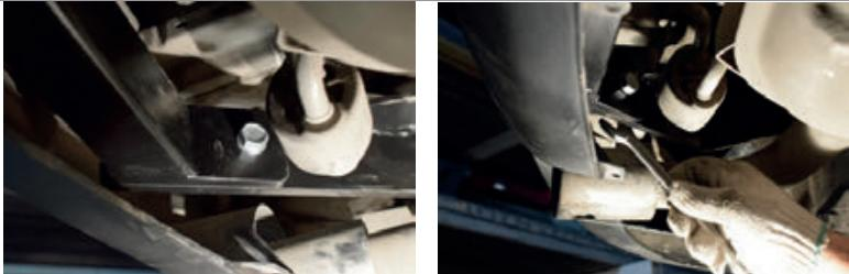
**ШАГ 4.** Затяните все соединения, отрегулировав положение ТСУ. Установите съёмный шар в сборе и закрепите его пальцем гнутым гальванизированным со шплинтом пружинным игольчатым. Затяните шар ключом на 38 мм. Установите фиксирующий болт M10x20 снизу, он используется для исключения технологических люфтов съемного шара и только в ненагруженном состоянии! Перед сцепкой болт демонтировать!
