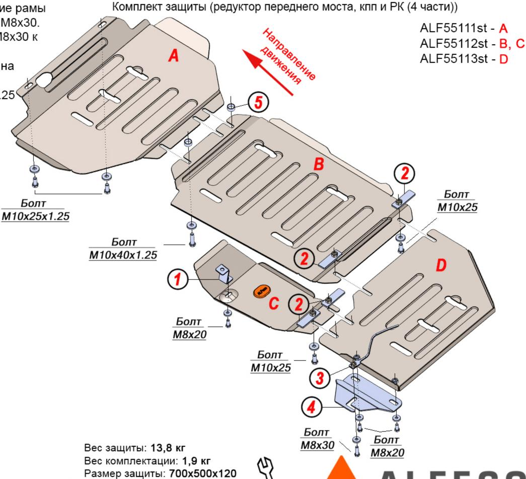
Момент затяжки: М8 - 15.7 Н\*м Момент затяжки: М10 - 32 Н\*м
