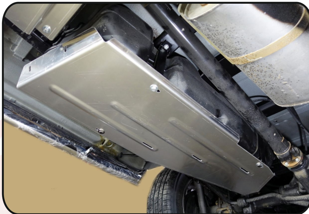
Защита бака (алюминий) 4мм арт.ZKTCC00214
