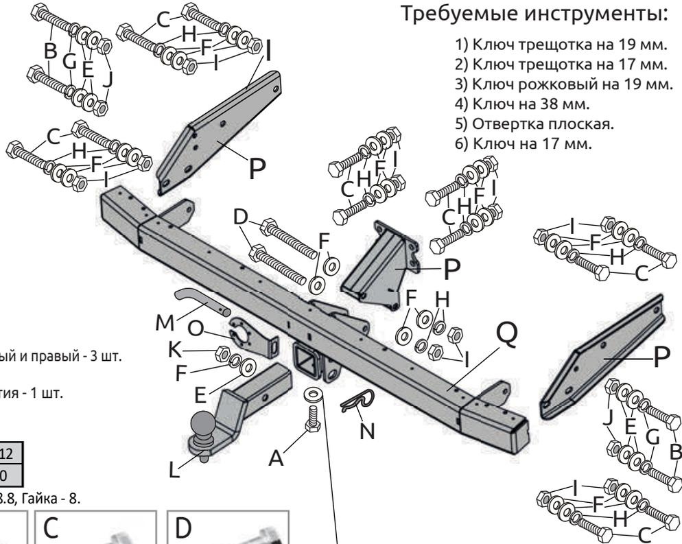
Table with 3 columns: Диаметр резьбы, M10, M12; Момент затяжки, Нм, 47, 80
