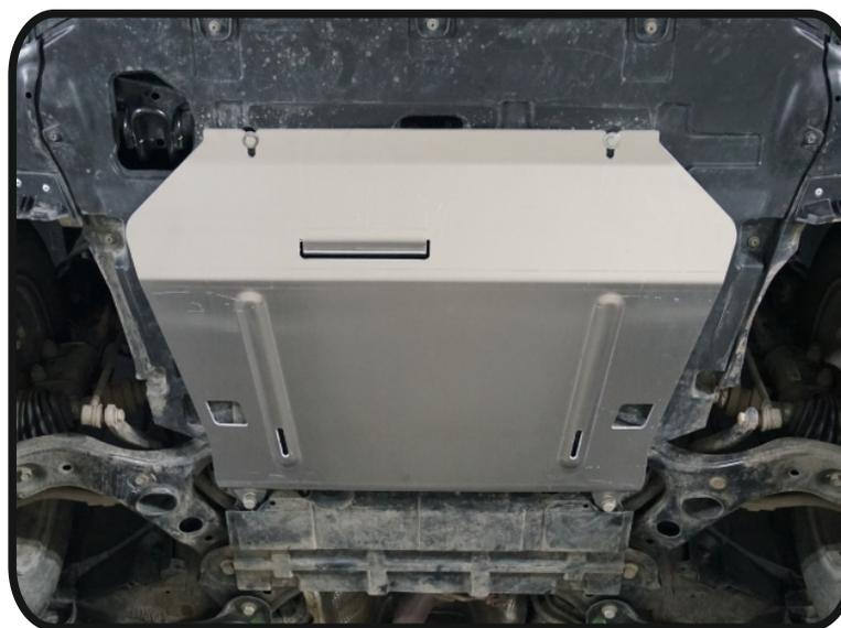
**Защита картера и КПП (алюминий) 4мм
