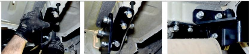
**ШАГ 4.** Для установки фаркопа совместите отверстия в балке ТСУ с резьбовыми отверстиями кронштейнов и соедините всё с помощью болтов M10x1,25x40, через шайбы 10, шайбы 10 гроверные и гайки M10x1,25. Затяните все резьбовые соединения.
