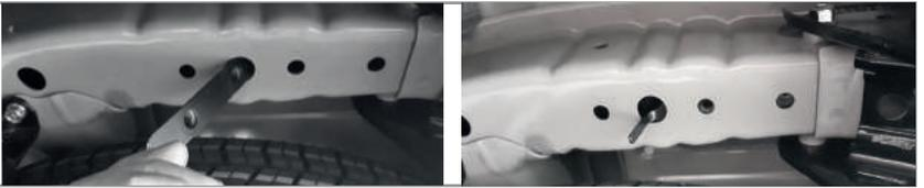
**ШАГ 2(2)** Установите кронштейн боковой с внутренней стороны лонжерона, гибом к центру авто и прикрутите его с помощью болтов M12x1,25x110, продетых сквозь лонжерон, гайками M12x1,25, через шайбы 12 и шайбы 12 гроверные.
