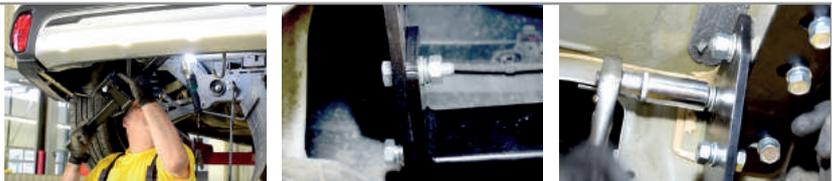
**ШАГ 5.** Установите усилитель и глушитель на место. Установите запасное колесо на место. Установите съёмный шар в сборе и закрепите его пальцем гнутым гальванизированным со шплинтом пружинным игольчатый. Затяните шар ключом на 38 мм.
