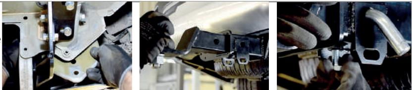
**ШАГ 5.** Установите фиксирующий болт M10x20 снизу, **он используется для исключения технологических люфтов съёмного шара и только в ненагруженном состоянии! Перед сцепкой болт демонтировать!**
