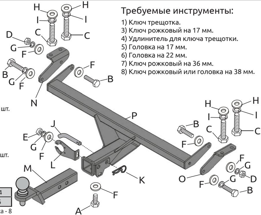
Table with 3 columns: Диаметр резьбы, M10, M14; Момент затяжки Нм, 47, 126
