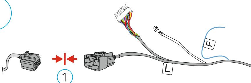
1. Соедините колодку из комплекта до щелчка в порядке, указанном на рисунке. Надежно закрепите.
