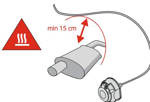
Монтаж кабеля производите на расстоянии более 15 см от выхлопной трубы.
