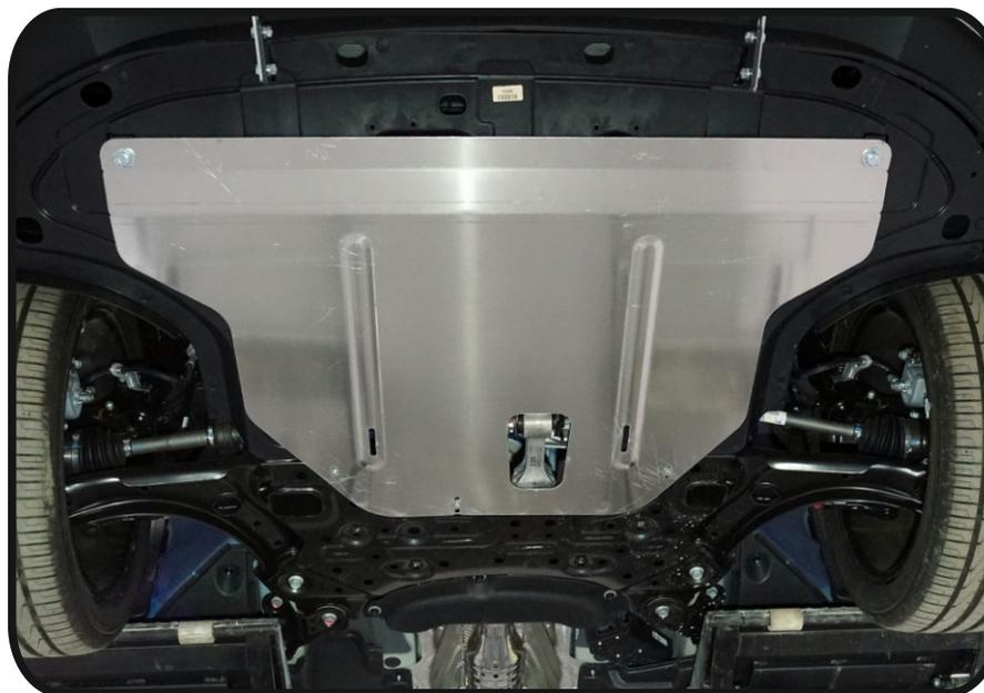
**Защита картера и кпп (алюминий) 4мм
