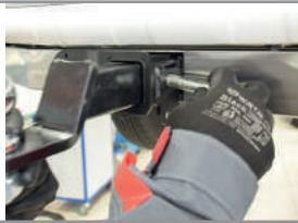
**ШАГ 4.** Зафиксируйте палец гнутый с помощью шплинта игольчатого.
