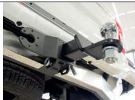
**ШАГ 5.** Зафиксируйте съемный шар болтом M10x20 снизу, он используется для исключения технологических люфтов съемного шара и только в ненагруженном состоянии! Перед сцепкой болт демонтировать!
