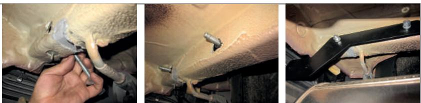
**ШАГ 4.** При необходимости подрежьте бампер с внутренней стороны. Установите балку ТСУ, прикрепив её к кронштейнам с помощью крепежных винтов из комплекта поставки. Установите шар в сборе и затяните его ключом на 38мм.
