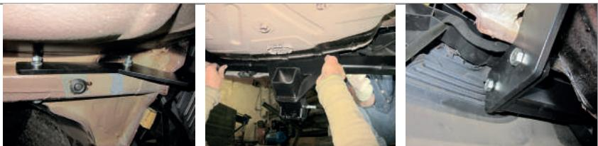
**ШАГ 5.** Установите кронштейн крепления электрической розетки, стопорный винт снизу, **используется для исключения технологических люфтов съемного шара и только в ненагруженном состоянии! Перед сцепкой болт демонтируется!**
