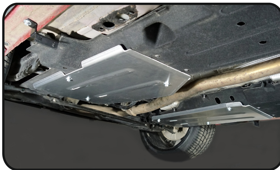
Защита бака и адсорбера (алюминий) 4мм арт.ZKTCC00477.
