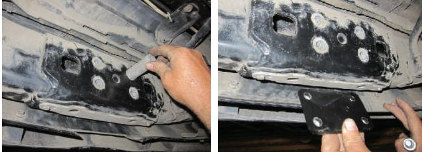
**ШАГ 3.** Установите центральный кронштейн вместе с центральной закладной (поз. N), совместив отверстия кронштейна с отверстиями в балке заднего бампера и закрепите всё с помощью четырёх болтов M12x120, через шайбы 12 гроверные, шайбы 12 с двух сторон, гайками M12 болтов M16x50 (через шайбы 16 гроверные) и двух болтов M6x35 снизу кронштейна.
