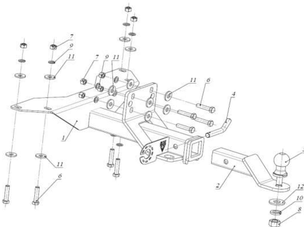
1. Установить раму 1, закрепив ее болтами М12х40 к поперечной балке и растяжкам рамы а/м (рис.1,2).
