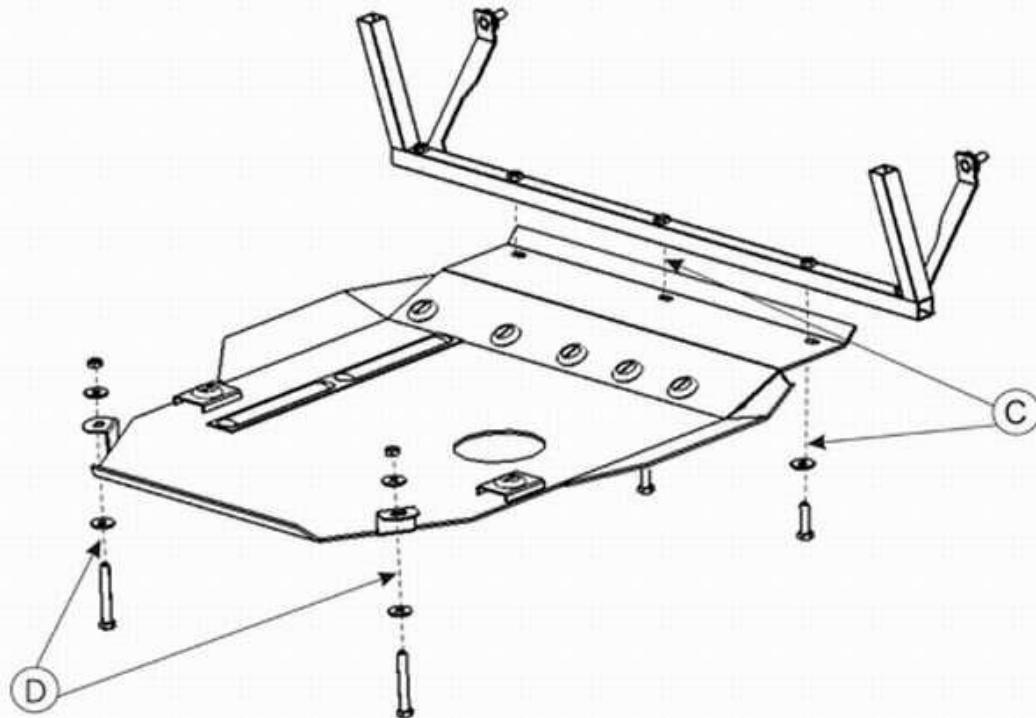
5. Переднюю часть защиты прикрепить к установленной балке болтами M 10x40.
