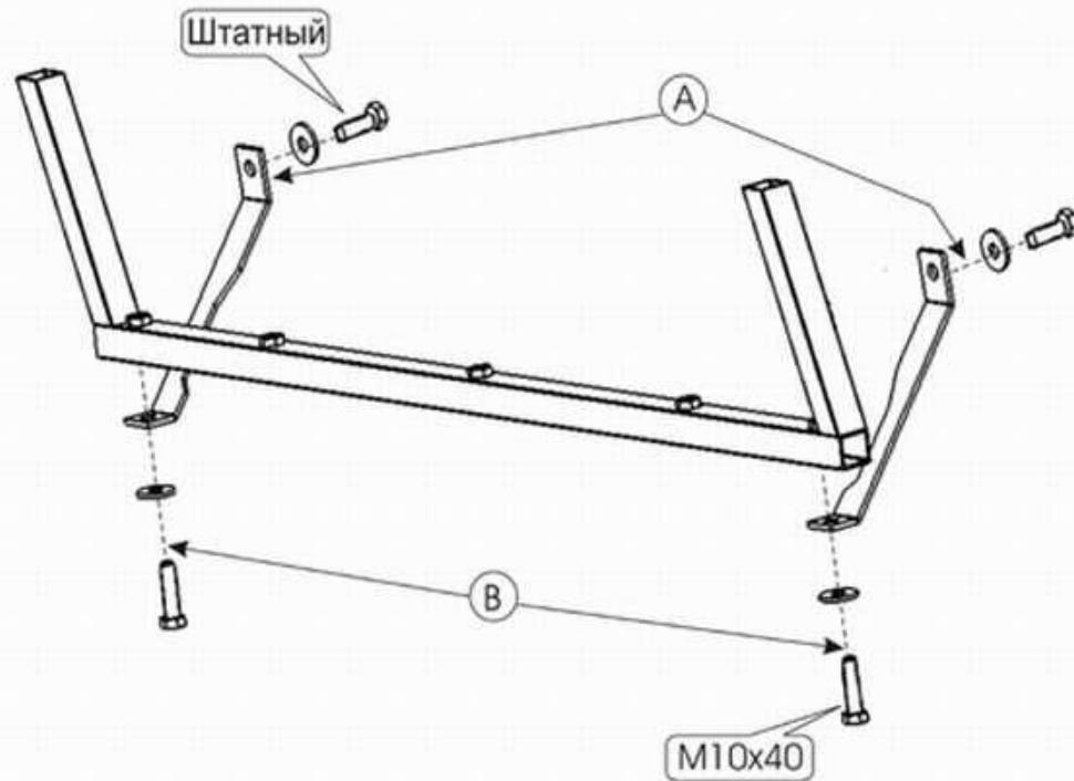
1. На переднем бампере снять лючки закрывающие доступ к фланцам крепления бампера.
