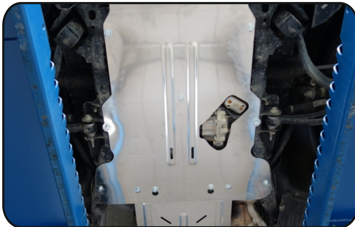
Защита картера (алюминий) 4мм арт.ZKTCC00312
