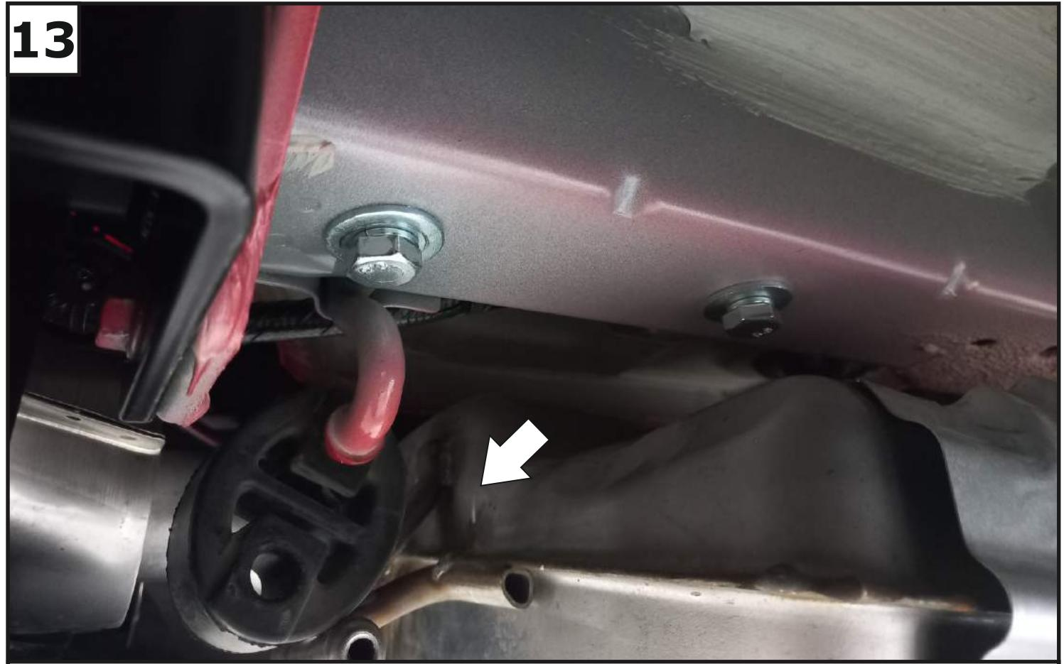
Установленные кронштейны (2 и 3) дополнительно закрепить с помощью болтов M8x30 (13), шайб 8 пружинных (22), шайб 8 увел. (24) и болтов M10x1,25x30 (16), шайб 10 пружинных (25) и шайб 10 увел. (27). Для удобства рекомендуется снять подвес глушителя.
