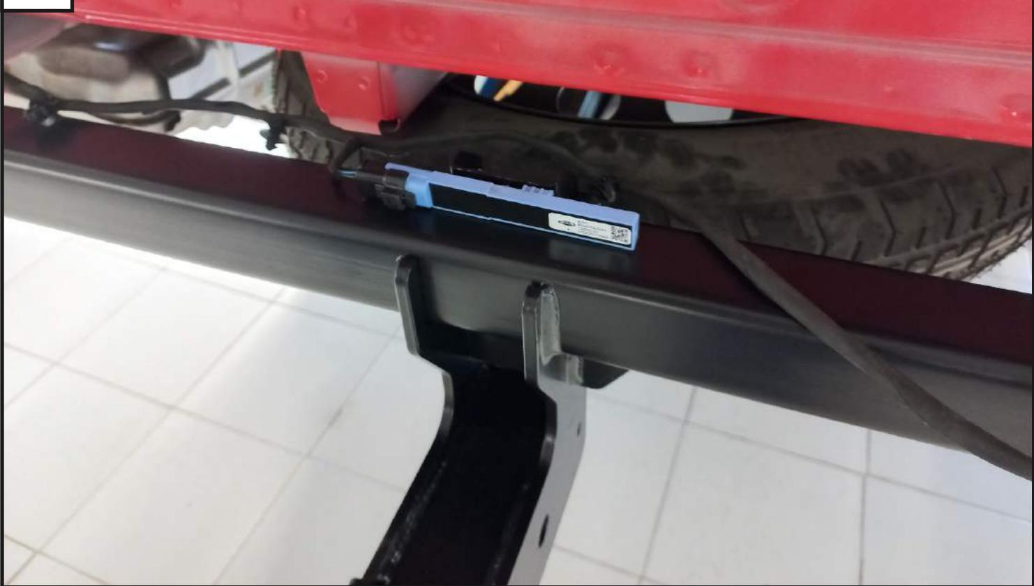
Установить кронштейн антенны (4) и закрепить с помощью болтов М6x20 (12), гаек М6 (17), шайб 6 пружинных (20) и шайб 6 (21).
