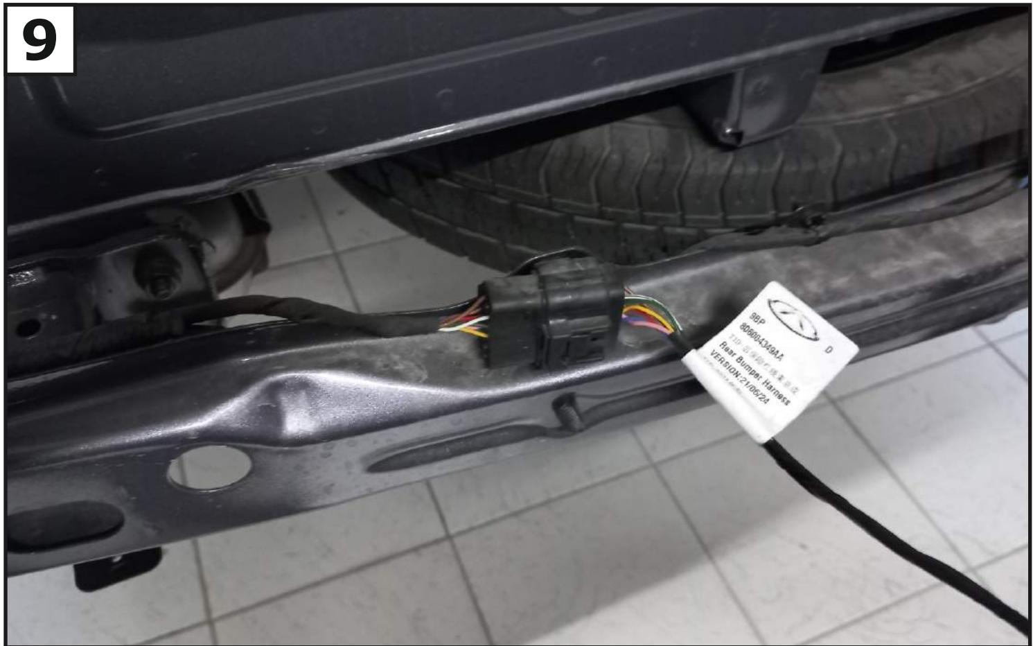
Для снятия заднего бампера необходимо отсоединить разъем проводки заднего бампера.
