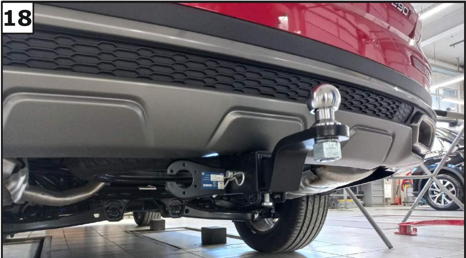
Установить кронштейн под розетку (11) на балку (1) с помощью болта M8x80 (14), шайбы 8 (23), шайбы 8 пружин. (22), шайбы 8 увел. (24) и гайки 8 (18). Установить переходник (7), закрепив с помощью штифта (9) и шплинта (10). Зафиксировать переходник болтом M10x20 (15) - фиксацию использовать только без нагрузки. Установить на переходник шар (8), закрепив гайкой M24 (28) с шайбой 24 пружинной (29).
