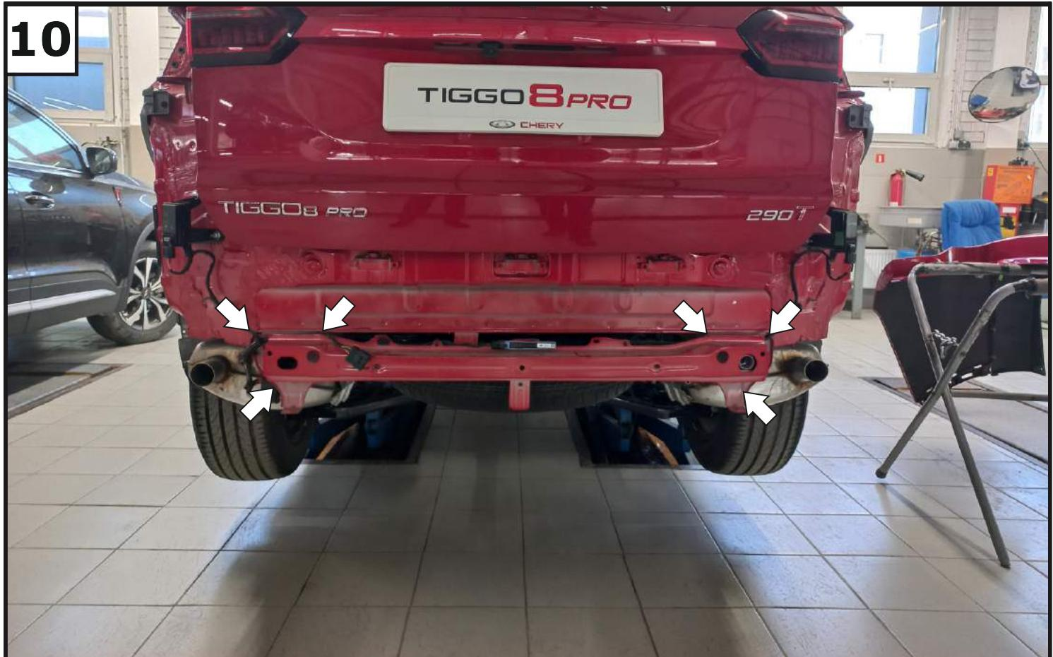
Отсоединить точки креплений проводки и антенну бесключевого доступа от заднего усилителя и открутить гайки крепления усилителя.
