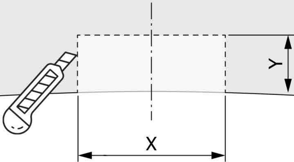
**Tiggo 8** $X=64 \text{ ММ}$  $Y=10 \text{ ММ}$ **Tiggo 8 pro/pro max** $X=64 \text{ ММ}$  $Y=25 \text{ ММ}$
