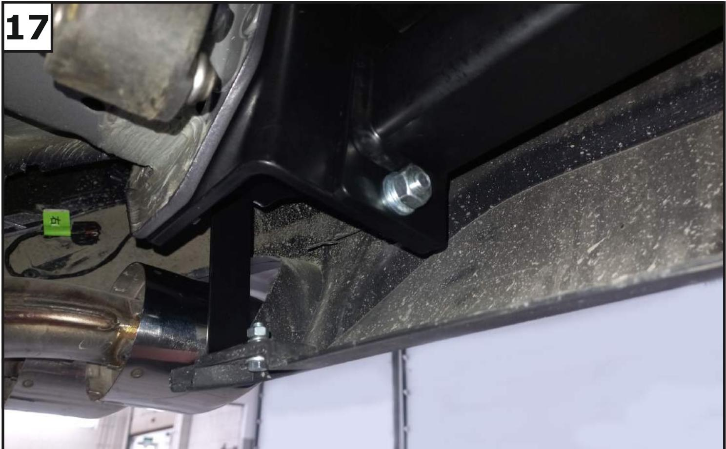
Установить крепления бампера (5 и 6) на кронштейны (2 и 3) с помощью болтов М6x20 (12), шайб 6 пружинных (20), шайб 6 (21) и гаек М6 (17). Бампер закрепить с помощью болтов М6x20 (12), шайб 6 пружинных (20), шайб 6 (21) и гаек М6 (17).
