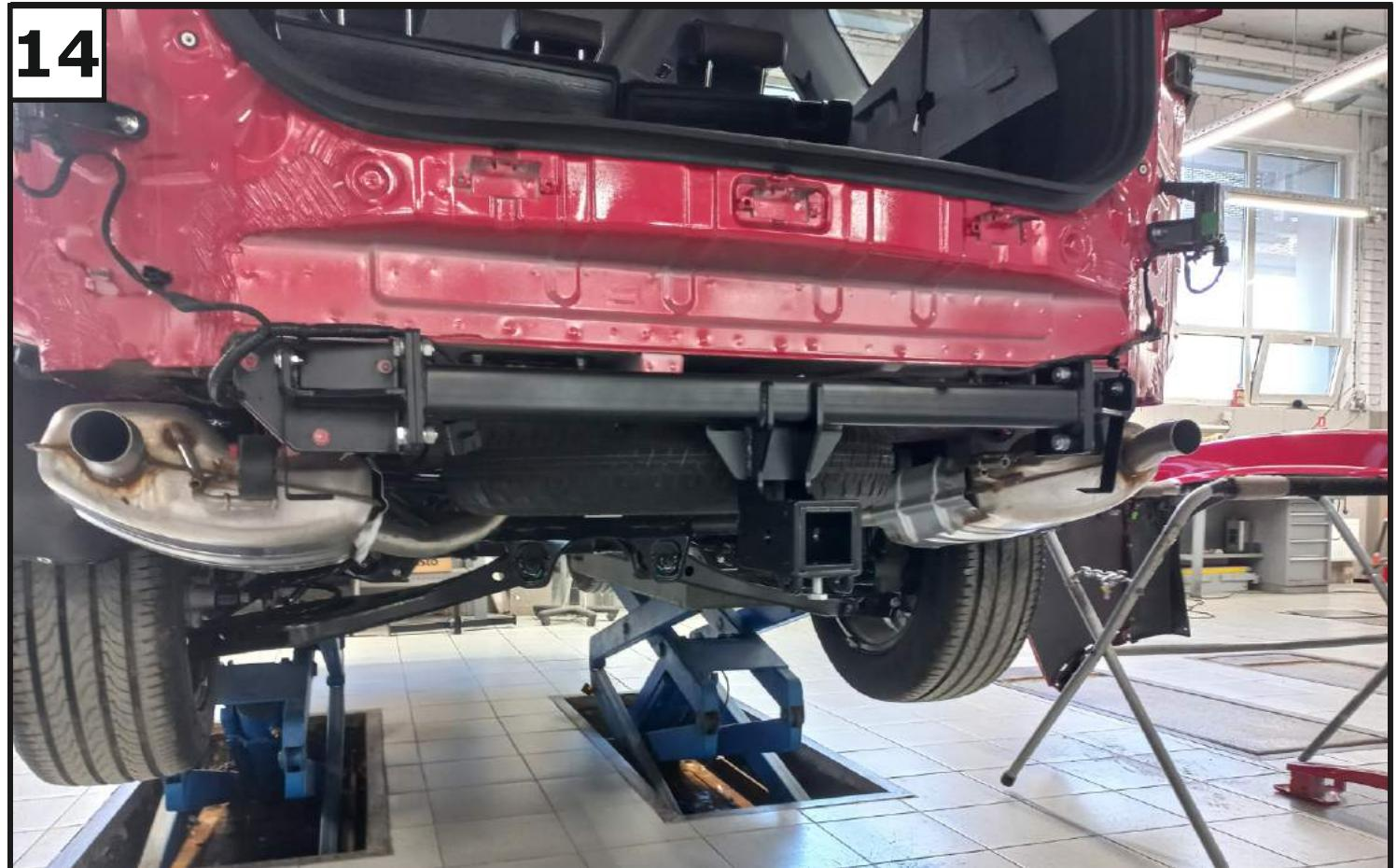
К кронштейнам закрепить балку (1) с помощью болтов M10x1,25x30 (16), гаек M10x1,25 (19), шайб 10 пружинных (25) и шайб 10 (26).
