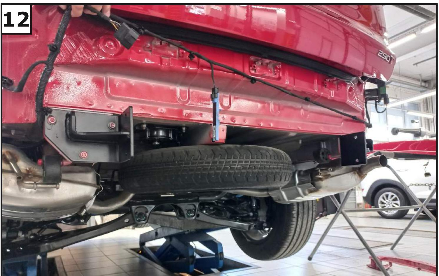
В лонжероны автомобиля установить левый и правый кронштейн (2 и 3), закрепив на штатные гайки крепления усилителя.
