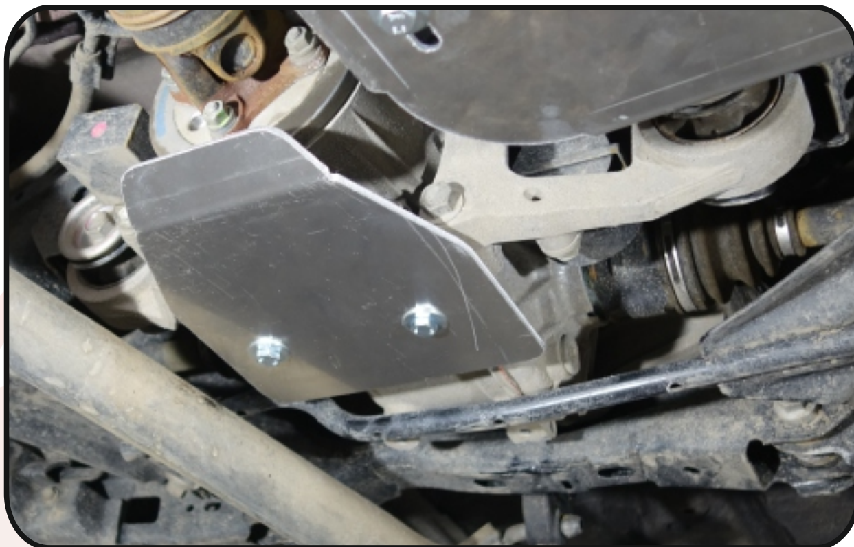
Защита дифференциала (алюминий) 4 мм арт. ZKTCC00339.
