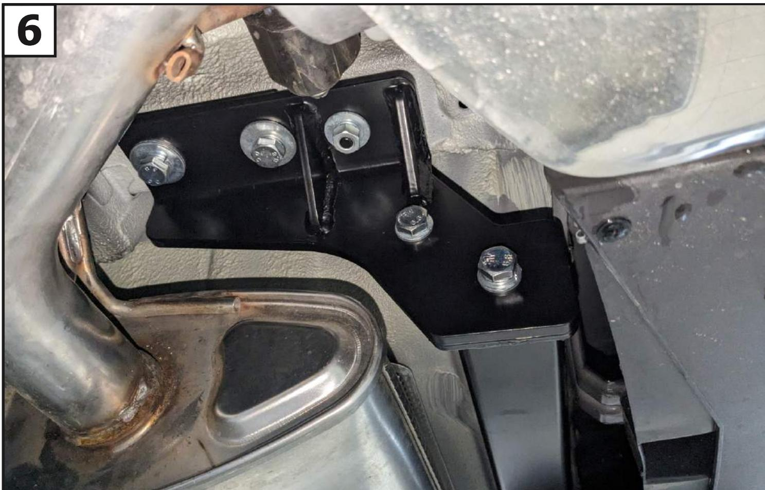
К установленным кронштейнам (2 и 3) закрепить балку (1) с помощью болтов М12х1,25х40 (10), шайб 12 пружинных (18), шайб 12 (17) и гаек М12х1,25 (14).
