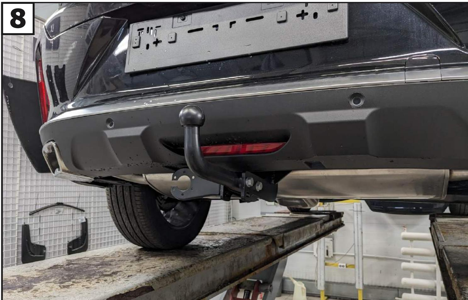
Установить подрозетник (4) и крюк (5) при помощи проставок (6), болтов М12х1,25х90 (12), шайб 12 пружинных (18), шайб 12 (17) и гаек М12х1,25 (14).
