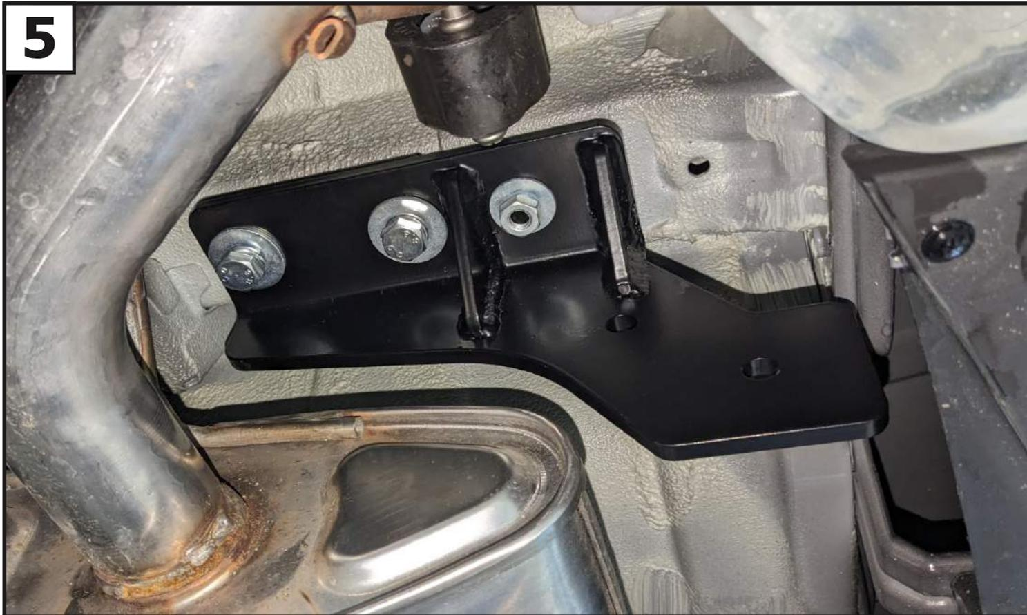
Установить левый кронштейн (2) совместно с проставками кронштейна (7), закрепив его к установленным закладным (8 и 9) с помощью болтов М12х1,25х45 (11), шайб 12 пруж. (18) и шайб 12 увел. (19), гаек М10х1,25 (13), шайб 10 пруж. (15) и шайб 10 увел. (16). Правый кронштейн (3) устанавливается аналогично.
