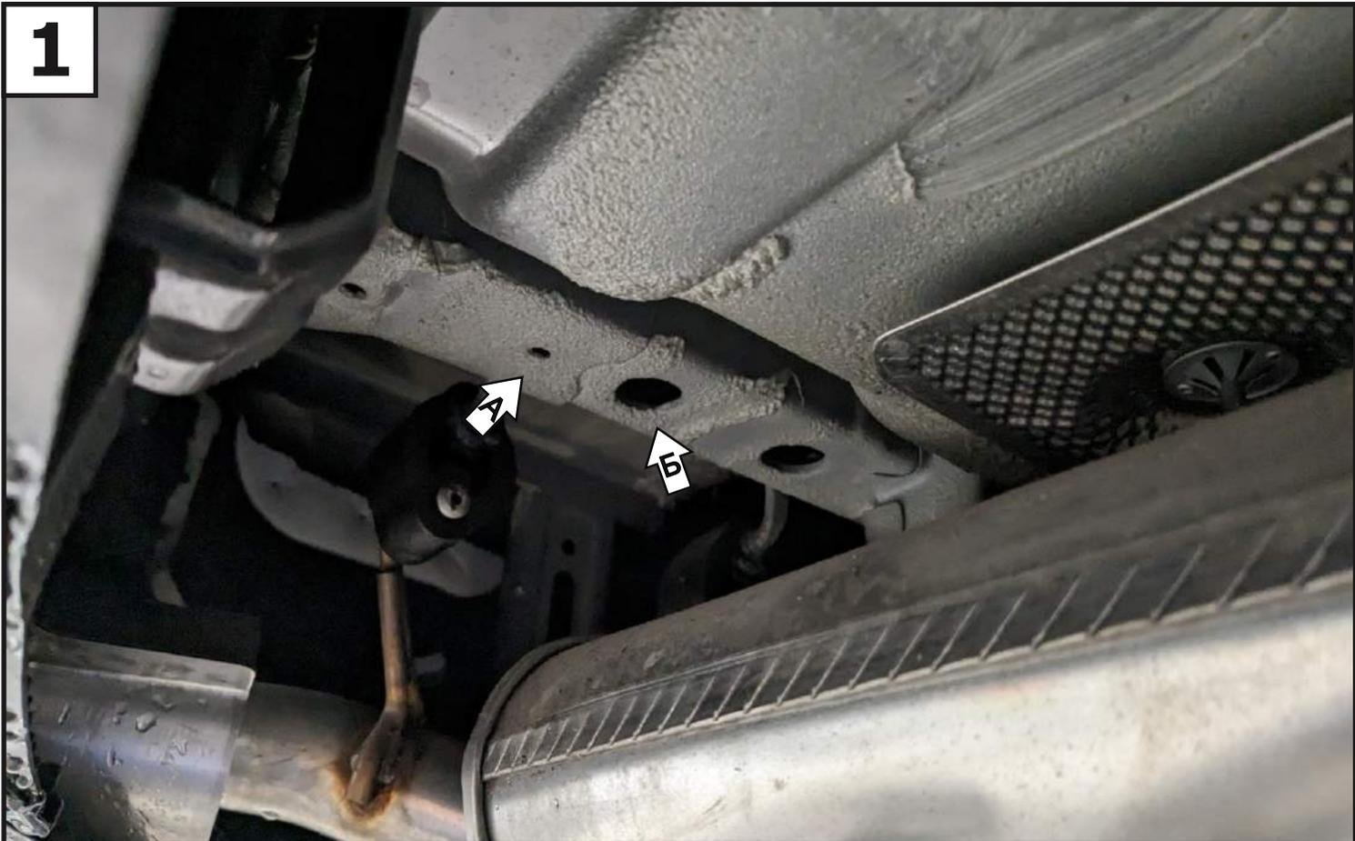
Установить закладную (8) в отверстие левого лонжерона А автомобиля через технологическое отверстие Б. С правой стороны аналогично.
