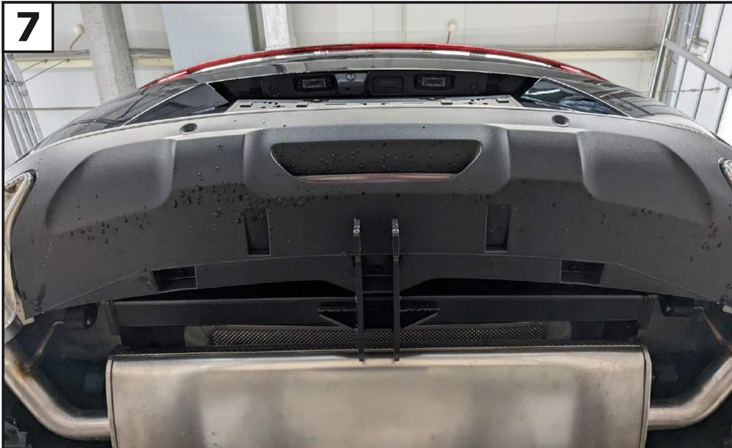
Отрегулировать положение ТСУ относительно центра автомобиля и затянуть все резьбовые соединения — сначала балку с кронштейнами, затем кронштейны с лонжеронами автомобиля. Моменты затяжки: М10=47 Нм, М12=81 Нм.
