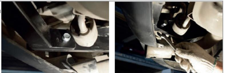
**ШАГ 4.** Затяните все соединения, отрегулировав положение ТСУ. Установите съёмный шар в сборе и закрепите его пальцем гнутым гальванизированным со шплинтом пружинным игольчатым. Затяните шар ключом на 38 мм. Установите фиксирующий болт М10х20 снизу, он используется для исключения технологических люфтов съёмного шара и только в ненагруженном состоянии! Перед сцепкой болт демонтировать!
