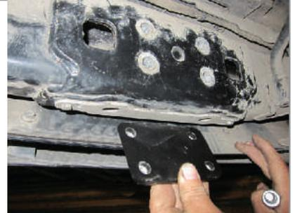
**ШАГ 3.** Установите центральный кронштейн ТСУ вместе с центральной закладной (поз. N), совместив отверстия кронштейна с отверстиями в балке заднего бампера и закрепите всё с помощью четырёх болтов M12x120, через гроверные шайбы 12, шайбы 12 с двух сторон, гайками M12 и двух болтов M16x50 (через шайбы 16 гроверные) и двух болтов M6x35 снизу кронштейна.
