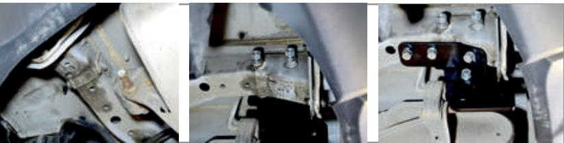
**ШАГ 3.** Установите пластины гнутую (поз. Р) и прикрутите её к лонжерону с помощью болтов M10x1,25x40 через шайбы 10 и к кронштейну с помощью болта M10x1,25x30 через шайбы 10 с двух сторон, шайбы 10 гроверные и гайки M10x1,25. Повторите шаги 2-3 для другой стороны.
