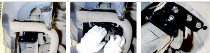
**ШАГ 4.** Для установки балки ТСУ совместите отверстия в кронштейне с резьбовыми отверстиями боковых кронштейнов и соедините помощью болтов M10x1,25x30, через шайбы 10. Затяните все резьбовые соединения.
