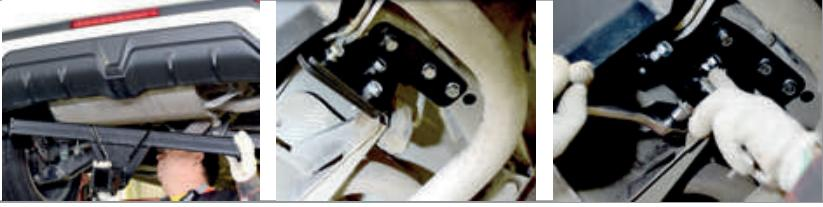
**ШАГ 5.** Закрепите кронштейн крепления электрической розетки гайкой M10 с шайбой. Установите съемный шар в сборе и закрепите его пальцем гнутым со сплинтом.
