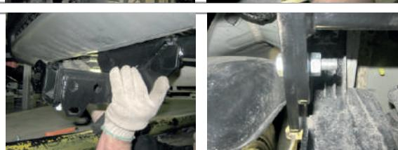
**ШАГ 4.** Установите кронштейн розетки и закрепите его на шпильке с помощью гайки M10 через шайбу 10 увеличенную и шайбу 10 гроверную. Установите съёмный шар в сборе и закрепите его пальцем гнутым гальванизированным со шплитом пружинным игольчатым. Затяните шар ключом на 38 мм.
