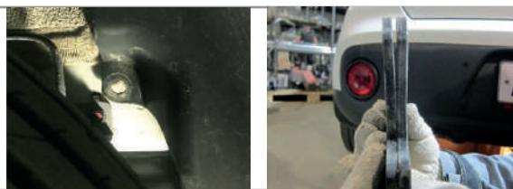
**ШАГ 2.** Для установки кронштейна бокового, отыщите два отверстия с закладными гайками в заднем лонжероне автомобиля. Прикрутите кронштейн к внешней, боковой стороне лонжерона с помощью болтов M10x1,25x40, через шайбы 10 и шайбы 10 гроверные. На другой стороне автомобиля кронштейн боковой устанавливается аналогично. Соединения не затягивайте
