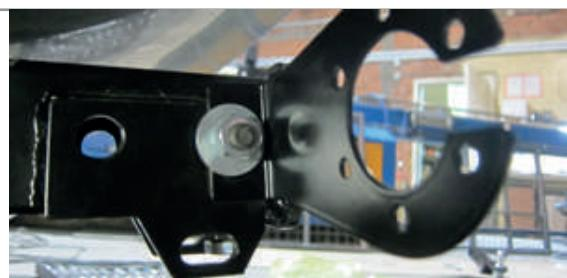
**ШАГ 5.** Установите фиксирующий болт M10x20 снизу, **он используется для исключения технологических люфтов съемного шара и только в ненагруженном состоянии!** Перед сцепкой болт демонтировать!
