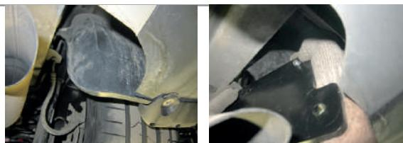
**ШАГ 3.** Установите балку ТСУ, совместив отверстия в кронштейнах боковых и балке ТСУ. Закрепите кронштейн с помощью болтов M10x40x1,25, гайками M10x1,25 через шайбы 10 и шайбы 10 гроверные. Отрегулируйте положение балки ТСУ относительно бампера и затяните все соединения.
