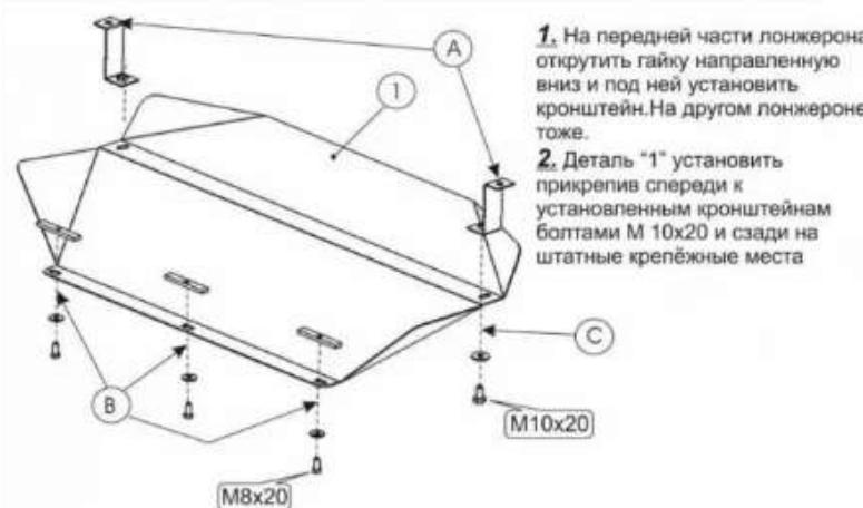
1. На передней части поперечина открутить гайку направленную вниз и под ней установить кронштейн. На другом поперечине тоже.
