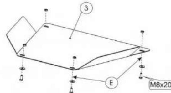
4. Деталь "3" устанавливается под коробкой передач на штатные места в продольных трубах.
