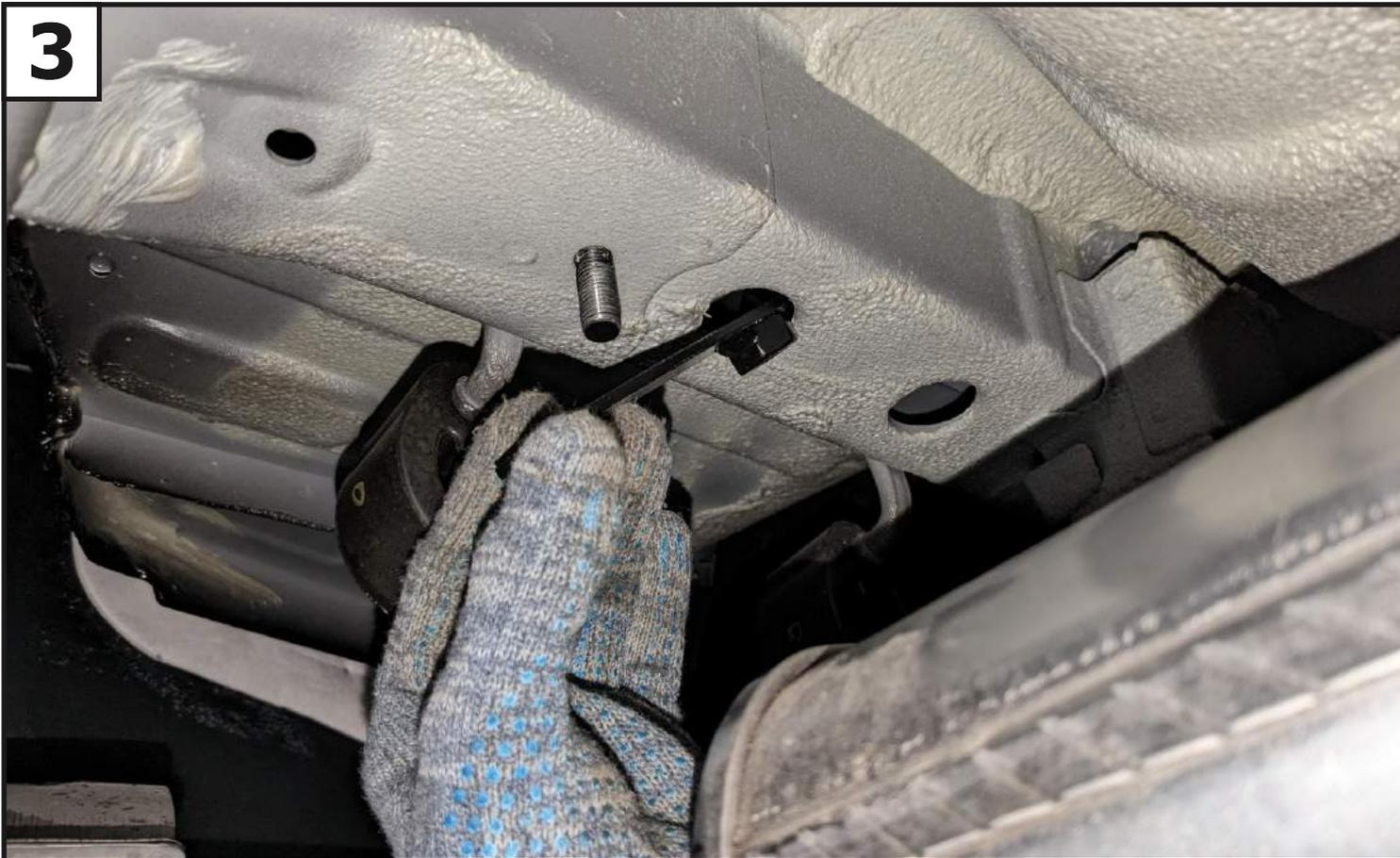
Установить закладную (11) в отверстие левого лонжерона и выставить ее соосно резьбовыми частями с отверстиями лонжерона. С правой стороны аналогично.
