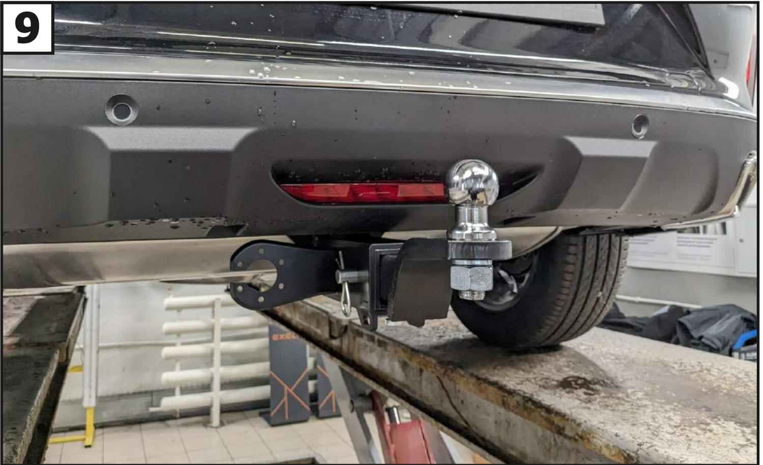
Установить переходник (4), закрепив с помощью штифта (6) и шплинта (7). Зафиксировать переходник болтом М10х20 (13) - фиксацию использовать только без нагрузки. Установить на переходник шар (5), закрепив гайкой М24 (27) с шайбой 24 пружинной (28).
