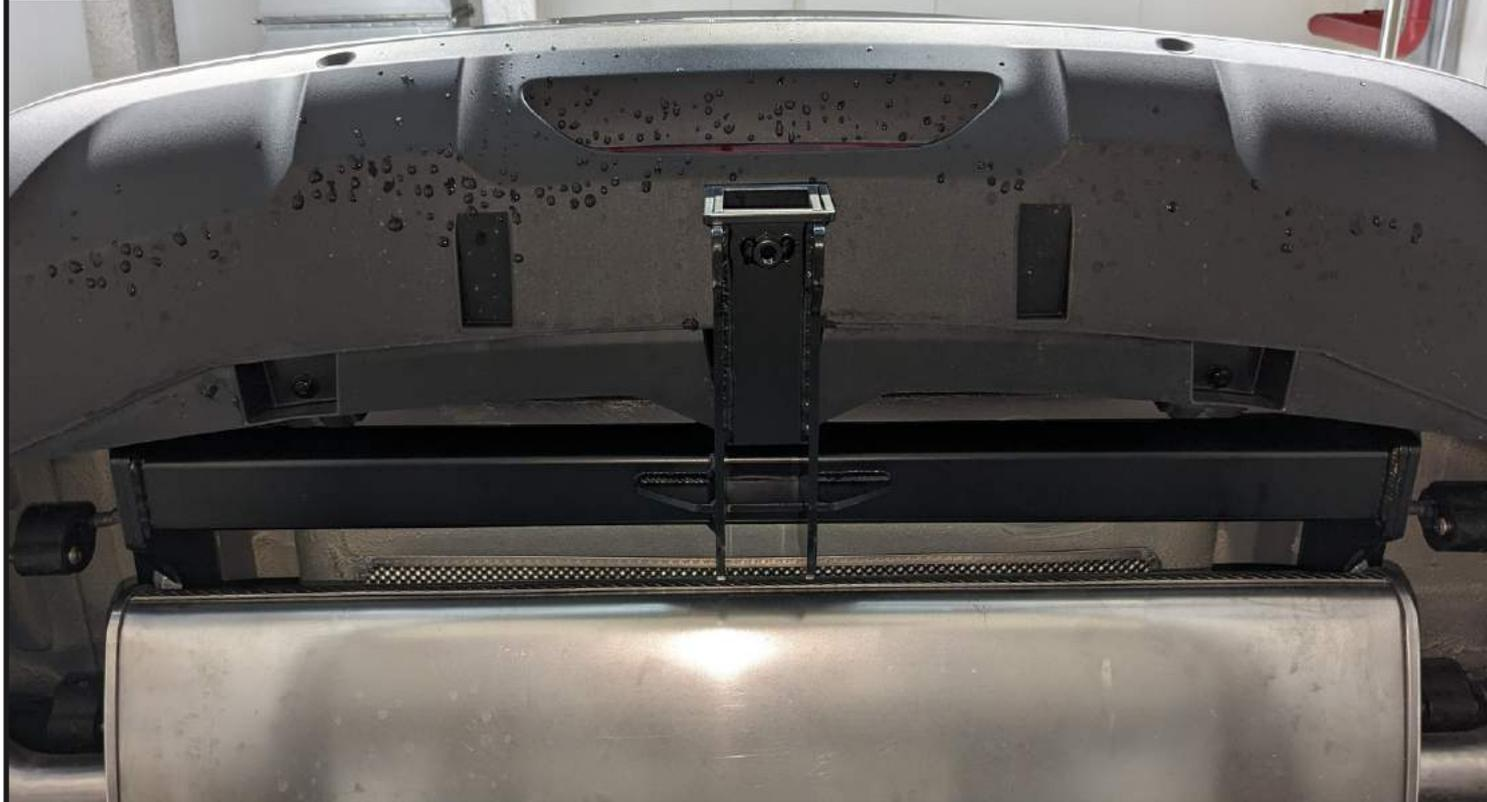
Отрегулировать положение ТСУ относительно центра автомобиля и затянуть все резьбовые соединения — сначала балку с кронштейнами, затем кронштейны с лонжеронами автомобиля. Моменты затяжки: M10=47 Нм, M12=81 Нм.
