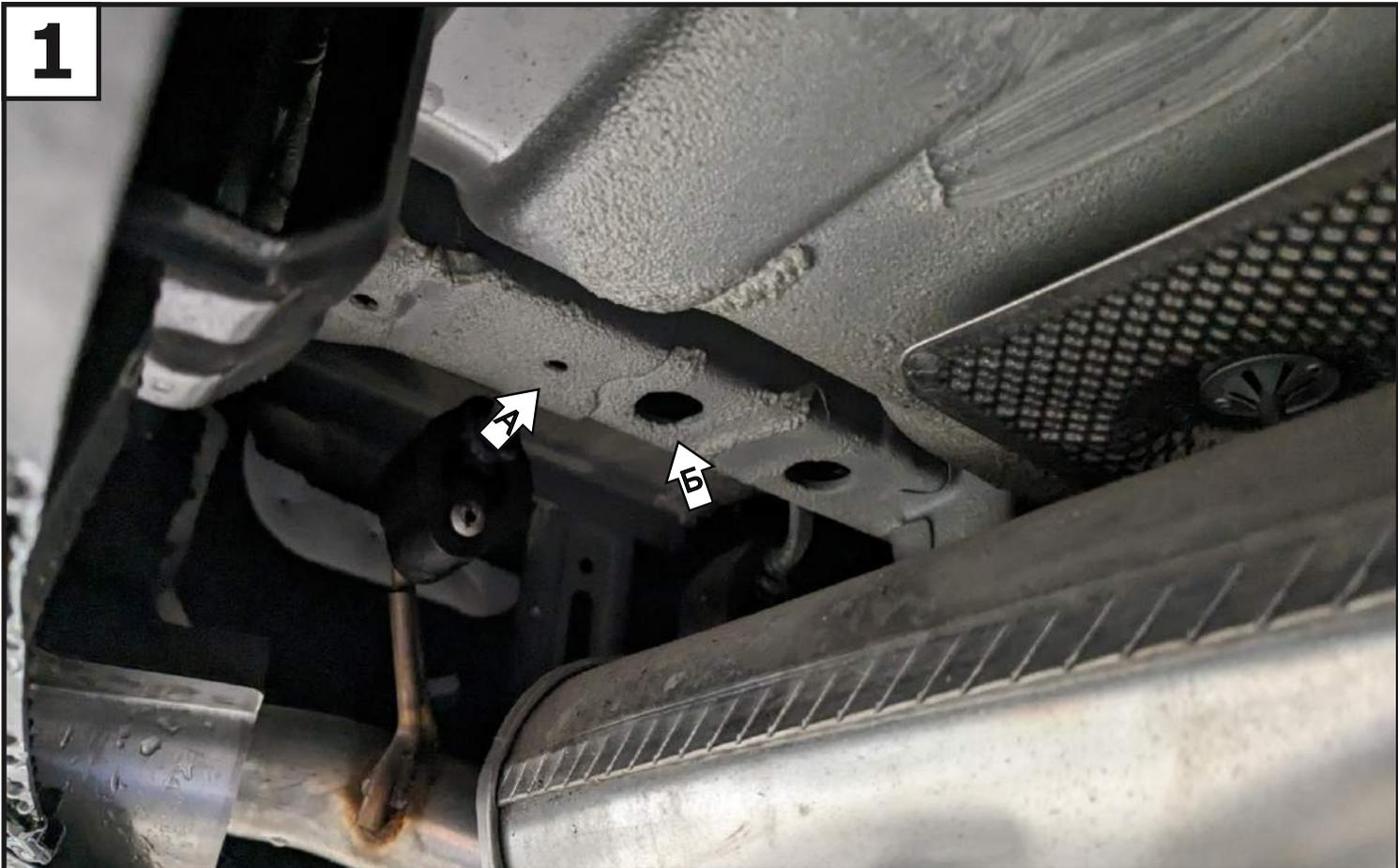
Установить закладную (10) в отверстие левого лонжерона А автомобиля через технологическое отверстие Б. С правой стороны аналогично.
