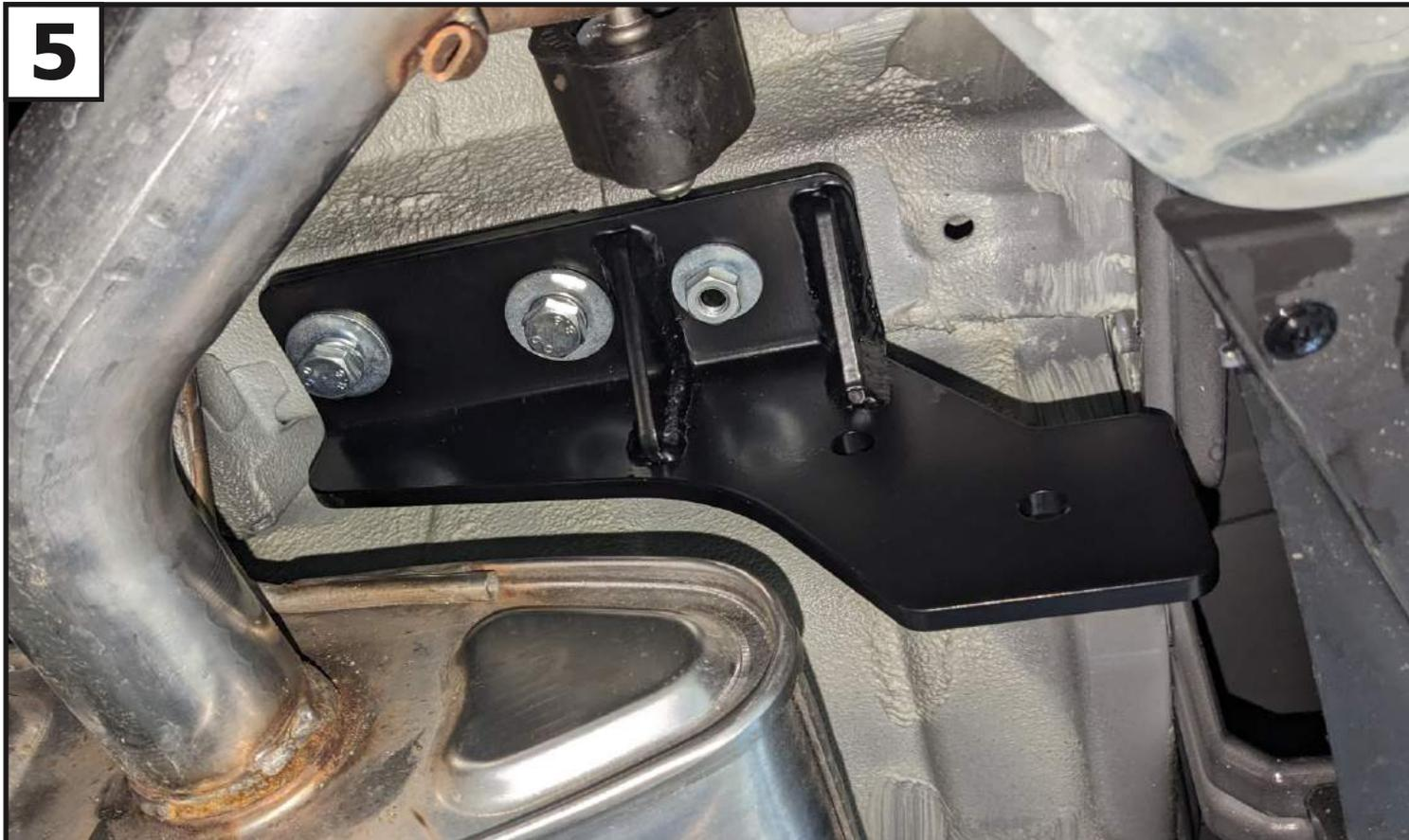
Установить левый кронштейн (2) совместно с проставками кронштейна (9), закрепив его к установленным закладным (10 и 11) с помощью болтов М12х1,25х45 (15), шайб 12 пруж. (25) и шайб 12 увел. (26), гаек М10х1,25 (17), шайб 10 пруж. (22) и шайб 10 увел. (23). Правый кронштейн (3) устанавливается аналогично.
