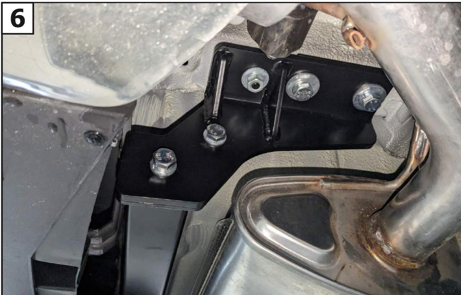
К установленным кронштейнам (2 и 3) закрепить балку (1) с помощью болтов М12х1,25х40 (14), шайб 12 пружинных (25), шайб 12 (24) и гаек М12х1,25 (18).
