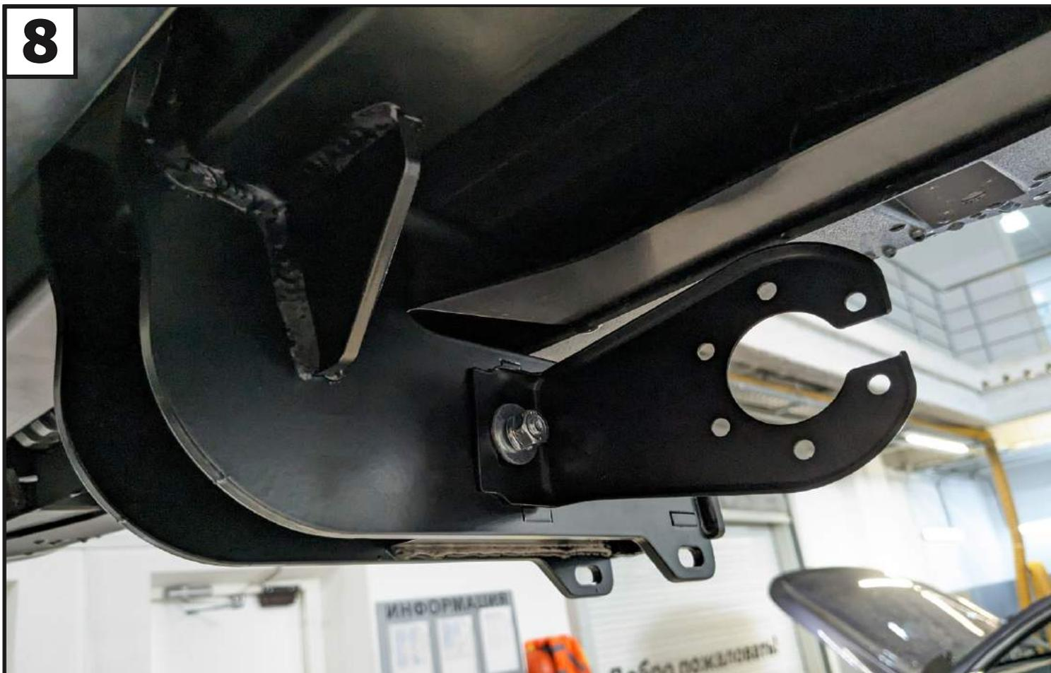
Установить кронштейн под розетку (8) на балку (1) с помощью болта M8x80 (12), шайбы 8 (19), шайбы 8 пружинной (20), шайбы 8 увел. (21) и гайки M8 (16).
