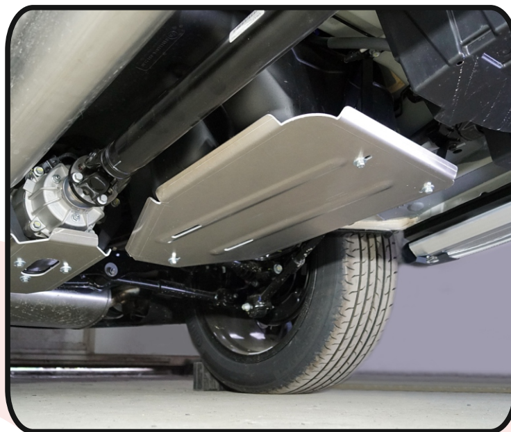
Защита бака (алюминий) 4 мм арт. ZKTCC00619.
