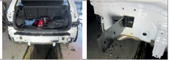
**ШАГ 2.** Закрепите каждую закладную пластину с помощью болта М10х1,25х40 и шайб 10 в дальнем отверстии закладной пластины. Установите балку ТСУ, совместив его отверстия с отверстиями в закладных пластинах и соедините их с помощью болтов М10х1,25х40, через шайбы 10 гроверные и шайбы 10, гайками М10х1,25.
