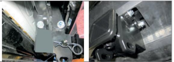
**ШАГ 5.** Установите съёмный шар в сборе и закрепите его пальцем гнутым гальванизированным со шплинтом пружинным игольчатый. Затяните шар ключом на 38 мм. Установите фиксирующий болт М10х20 снизу, **он используется для исключения технологических люфтов съёмного шара и только в ненагруженном состоянии! Перед сцепкой болт демонтировать!**
