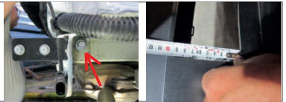
**ШАГ 4.** Установите бампер и фонари на место. Установите кронштейн нижний, совместив отверстия в нём с отверстиями в балке ТСУ. Закрепите нижний кронштейн с помощью болтов М12х1,25х120 и гаек М12х1,25 с нейлоном. Установите кронштейн розетки, закрепив его на шпильке гайкой М10 через шайбу 10 увеличенную и шайбу 10 гроверную.
