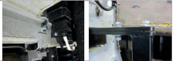
**ШАГ 3.** Закрепите каждую закладную пластину в ближнем отверстии с помощью болта М10х1,25х40 через шайбу 10 гроверную и шайбу 10. Затяните все резьбовые соединения. **Перед установкой бампера** наклейте на нижнюю юбку бампера шаблон по центру бампера и аккуратно вырежьте по контуру шаблона отверстие в бампере.
