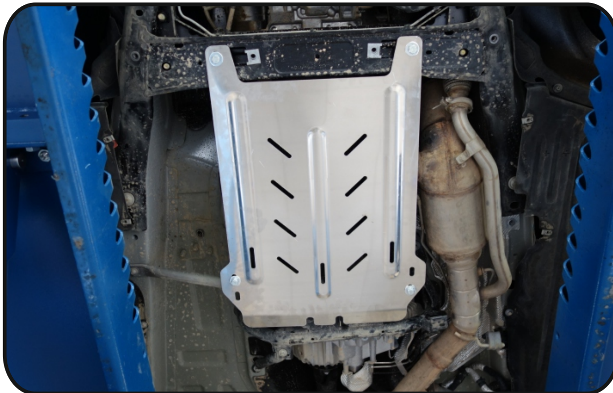
Защита КПП(алюминий) 4мм арт.ZKTCC00313.
