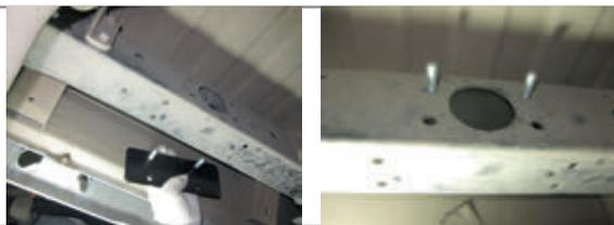
**ШАГ 2.** Установите кронштейн центральный и закрепите его болтами М10х1,25х40 с помощью гаек М10х1,25 через шайбы 10 и шайбы 10 гроверные, как показано на схеме. Соединения не затягивать.
