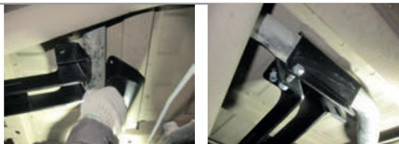
**ШАГ 4.** Отрегулируйте положение центрального кронштейна и затяните все резьбовые соединения. Установите кронштейн розетки и закрепите его на шпильке с помощью гайки М10, через шайбу 10 увеличенную и шайбу 10 гроверную.
