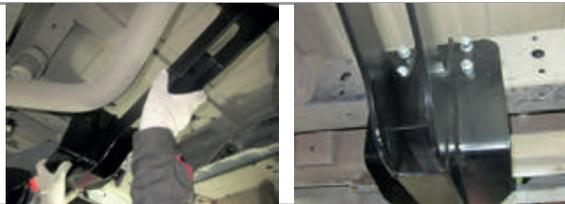
**ШАГ 3.** Закрепите кронштейн центральный на круглой балке с помощью кронштейна гнутого, соединив обе детали с помощью двух болтов М10х1,25х40 через шайбы 10 и гроверные 10, гайками М10х1,25, и болтов М12х1,25х45 через шайбы 12 и шайбы 12 гроверные, гайками М12х1,25 снизу, как показано на схеме. Соединения не затягивать.
