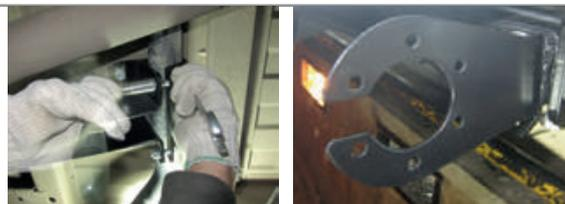
**ШАГ 5.** Установите съёмный шар в сборе и закрепите его пальцем гнутым гальванизированным со шплинтом пружинным игольчатым. Затяните шар ключом на 38 мм. Установите фиксирующий болт М10х20 снизу, **он используется для исключения технологических люфтов съёмного шара и только в ненагруженном состоянии! Перед сцепкой болт демонтировать!**
