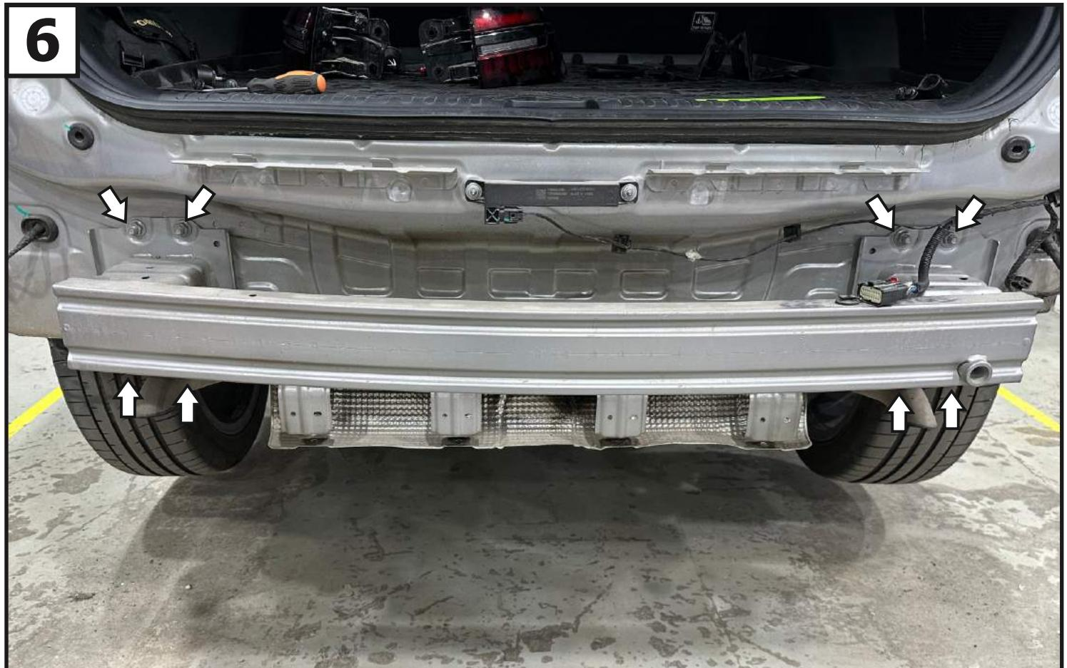
Открутить гайки крепления усилителя заднего бампера.
