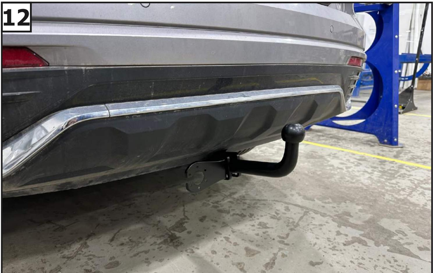
**Установить кронштейн под розетку (5), и крюк (4) с помощью болтов M12x1,25x70 (7), шайб 12 (10), пружинных шайб 12 (9), и гаек M12x1,25 (8).**
