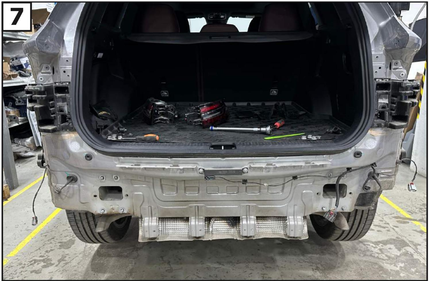
Снять усилитель бампера.
