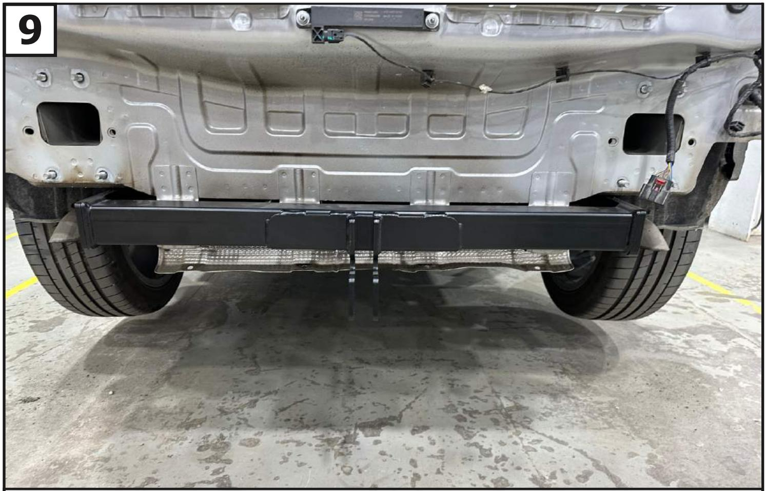
Установить балку (1), закрепив к кронштейнам болтами M12x1,25x40 (6), гайками M12x1,25 (8), шайбами 12 пружинными (9) и шайбами 12 (10).
