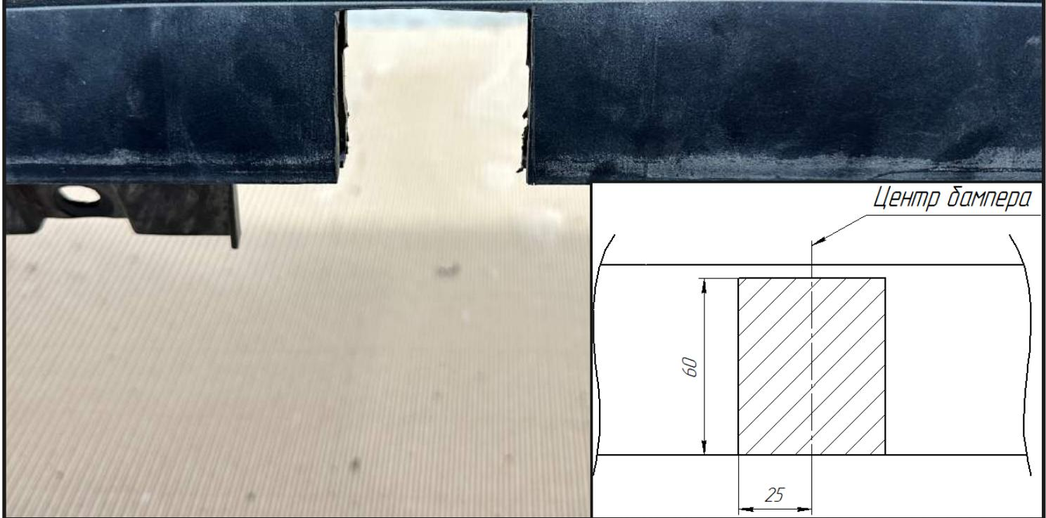
**По центру сделать вырез заднего бампера согласно схеме. После установить бампер в обратной последовательности.**
