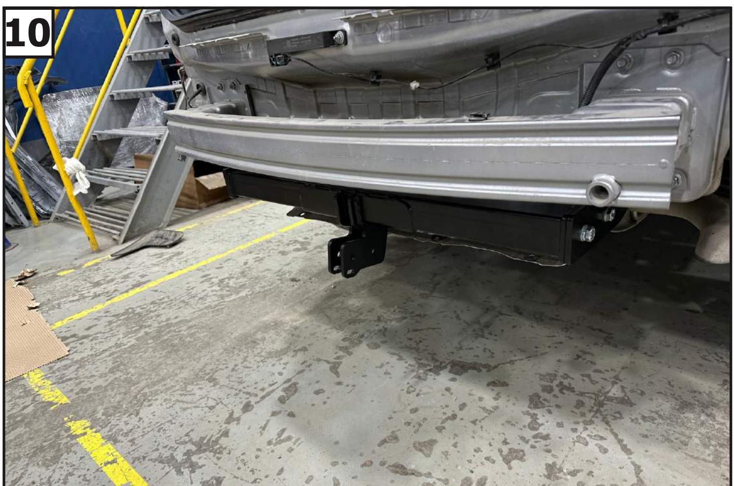
Затянуть все резьбовые соединения, сначала затянуть балку с кронштейнами, затем кронштейны к лонжеронам. Моменты затяжки: M12=81 Нм. После установить усилитель бампера.
