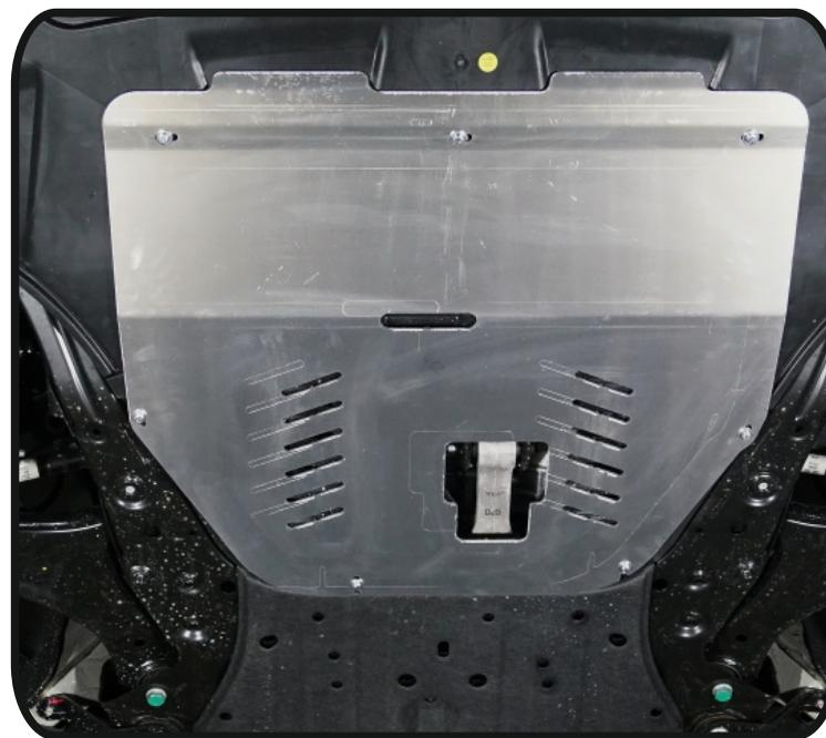
**Защита картера и кпп (алюминий) 4мм
