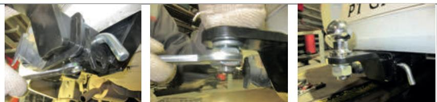
**ШАГ 5.** Установите фиксирующий болт M10x20 снизу, он используется для исключения технологических люфтов съемного шара и только в ненагруженном состоянии!
