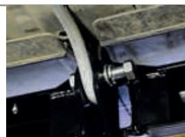
**ШАГ 5.** Затяните все резьбовые соединения. Закрепите глушитель. Установите съёмный шар в сборе и закрепите его пальцем гнутым с шплинтом. Зафиксируйте съёмный шар винтом M10x20 снизу. Затяните шар с помощью ключа рожкового или головки на 38мм.
