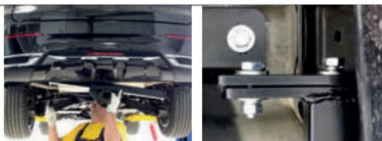
**ШАГ 5.** Затяните все резьбовые соединения. Закрепите кронштейн розетки гайкой М10 через шайбу и шайбу 10 гроверную. Установите съёмный шар в сборе и закрепите его пальцем гнутым со шплинтом. Зафиксируйте съёмный шар винтом М10х20 снизу. Затяните шар с помощью ключа рожкового или головки на 38мм.
