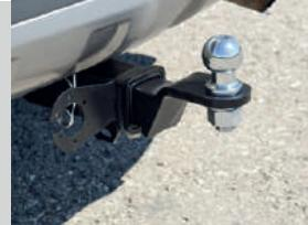
Тип соединения: шаровый; Диаметр сцепного шара: 50 мм.; Масса комплекта ТСУ OPA991101: 15,4 кг.
