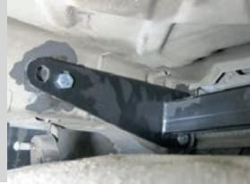
**ШАГ 4.** Установите кронштейн розетки, закрепив его на шпильке гайкой M10 через шайбу увеличенную на 10 и шайбу пружинную на 10.
