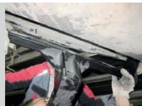
**ШАГ 2.** Закрепите сварной кронштейн, совместив его отверстия с отверстиями в лонжеронах автомобиля. Прикрутите кронштейн к штатным закладным гайкам в лонжеронах автомобиля с помощью болтов M12x40, через шайбы пружинные на 12 и шайбы на 12.
