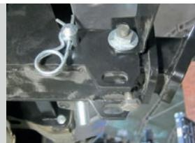
**ШАГ 5.** Затяните шар с помощью ключа на 38 мм.
