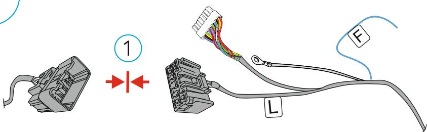
1. Соедините колодку из комплекта до щелчка в порядке, указанном на рисунке. Надежно закрепите.
