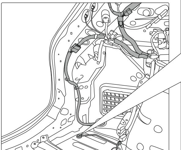
1. Просверлите отверстие в штатной заглушке автомобиля, подобрав сверло согласно диаметру кабеля.
