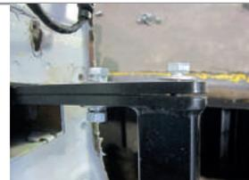
**ШАГ 3.** Закрепите каждую закладную пластину в ближнем отверстии с помощью болта М10х1,25х40 через шайбу 10 гроверную и шайбу 10. Затяните все резьбовые соединения. **Перед установкой бампера** наклейте на нижнюю юбку бампера шаблон по центру бампера и аккуратно вырежьте по контуру шаблона отверстие в бампере.
