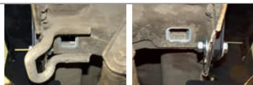
**ШАГ 3.** Установите закладные пластины гайками M12x1,25 вверх в квадратные технологические отверстия. С помощью дрели или шуруповорота со сверлом на 16мм расширьте круглые технологические отверстия во внутренних стенках боковых лонжеронов.
