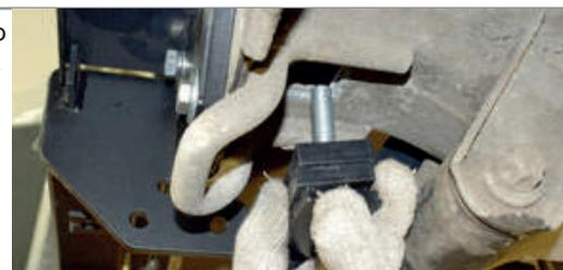
**ШАГ 5.** Соедините кронштейны боковые и балку ТСУ с помощью болтов M12x1,25x40 с шайбами 12 с двух сторон и шайбами 12 гроверными с гайками M12x1,25.
