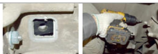
**ШАГ 4.** Установите боковые кронштейны, закрепив их в закладных с помощью болтов M12x1,25x60 через дистанционные пластины - по две с каждой стороны. Задние части кронштейнов зафиксируйте болтами M12x130 с надетыми на них шайбами и втулками, продев их сквозь лонжерон, и закрепив гайками M12 через шайбы 12 и шайбы 12 гроверные.
