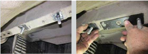
**ШАГ 3.** Установите центральный кронштейн совместив отверстия в боковых кронштейнах и в центральном. Закрепите кронштейн центральный с помощью болтов M10x30x1,25 через шайбы на 10 и гроверы на 10 гайками M10x1,25.
