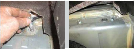
**ШАГ 2.** Установите кронштейны и закрепите их на болтах M12x110x1,25 с помощью гаек M12x1,25 через шайбы и гроверы как показано на схеме.
