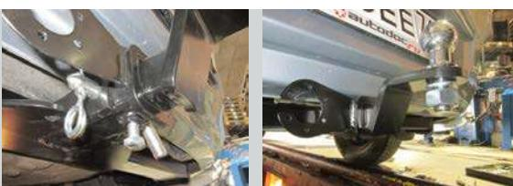
Тип соединения: шаровый; Диаметр сцепного шара: 50 мм.; Масса комплекта ТСУ 02041501: 16,2 кг.
