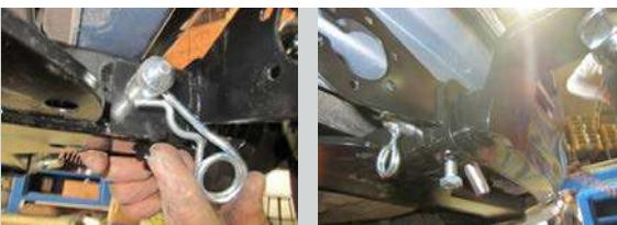
**ШАГ 5.** Зафиксируйте съемный шар болтом M10x20 снизу.
