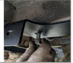
**ШАГ 4.** Установите балку ТСУ, на левый и правый кронштейны используя для крепления болты М10х1,25х30, гайки М10, шайбы 10 гроверные и шайбы 10. Отрегулируйте положение балки и затяните все резьбовые соединения. Подключите датчик, ранее закрепленный на балке ТСУ. Установите кронштейн крепления электрической розетки на балку ТСУ, используя болт М10х30, гайку М10, шайбу 10 гроверную и шайбу 10.
