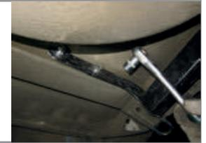
**ШАГ 5.** Установите кронштейн крепления электрической розетки. Установите съемный шар в сборе и закрепите его пальцем гнутым с шплинтом. Затяните шар ключом на 38 мм.
