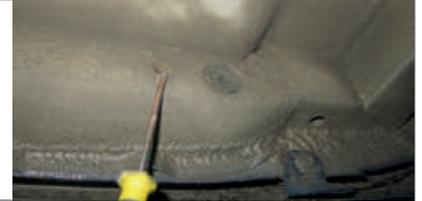
**ШАГ 3.** Для установки фаркопа совместите отверстия в балке ТСУ с резьбовыми отверстиями кузова автомобиля и соедините всё с помощью болтов М10, через шайбы 10 увеличенные и шайбы 10 гроверные.
