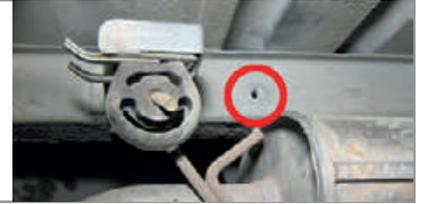
**ШАГ 2.** Отыщите два резьбовых отверстия в задней балке автомобиля, при необходимости прочистите отверстия от грязи.
