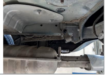
**ШАГ 2.** Установите правый кронштейн, совместив отверстия кронштейна с отверстиями в лонжероне автомобиля, и зафиксируйте его положение с помощью болтов M12x1,25x110, шайб 12, шайб 12 гроверных, гаек M12x1,25, болтов M10x1,25x30, шайб 10 увеличенных и шайб 10 гроверных. Аналогичным образом зафиксируйте положение левого кронштейна.
